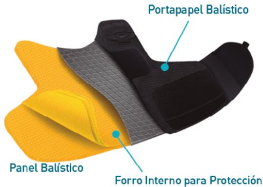
Para la confección del panel balístico se utilizan fibras tejidas altamente resistentes denominadas fibras aramídicas, comercializadas con el nombre de «kevlar» (Fig. N° 2) o «twaron», o fibras de polietileno, que se comercializan bajo la denominación «spectra» (Fig N° 3) y «dyneema».
