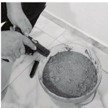
4. Verificación visual: para poder realizarla es necesario llevar la corredera hacia atrás y una vez que se produce el tope, se procede al accionamiento de la palanca retén de corredera hacia arriba. De esa forma voy a poder contar con el mecanismo abierto, teniendo poder visual del interior de la recámara, espaldón de la corredera y el alojamiento del cargador.
