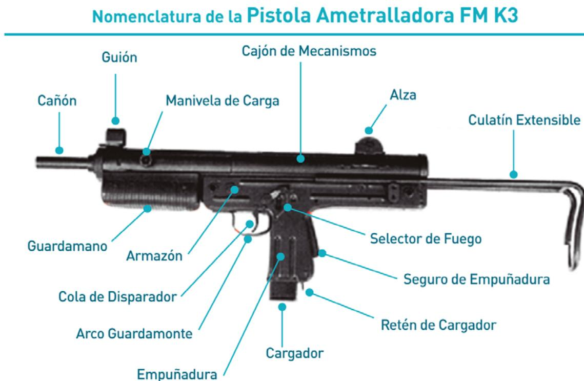
Alguna de las diferencias que podemos señalar, está dada por la ubicación de algunas palancas, mecanismos o la graduación del alza. Respecto al selector de fuego, la palanca selectora se desplaza en forma de media luna, activándose el seguro cuando la palanca se encuentra hacia arriba identificada con la letra «S» (Fig. N° 1).
