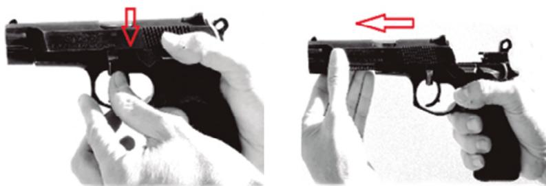
8.3. Se colocará el dedo pulgar de la mano que asiste sobre la cabeza del vástago y se ejercerá una presión controlada hacia el lado contrario de donde se halla, para que de esta forma se pueda retirar fácilmente, con una simple dirección del mismo hacia arriba.
